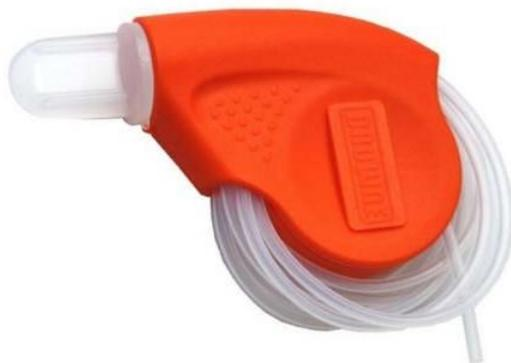
Тест Helix имитирует работу устройства при загрузке пустотелых предметов для стерилизации, в частности:
